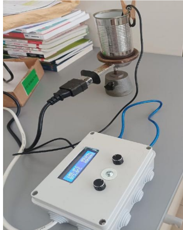
Fig. 13-14 : campione di terreno del giardino (a sinistra) e il terreno riscaldato sul riscaldatore collegato al dispositivo (a destra)
