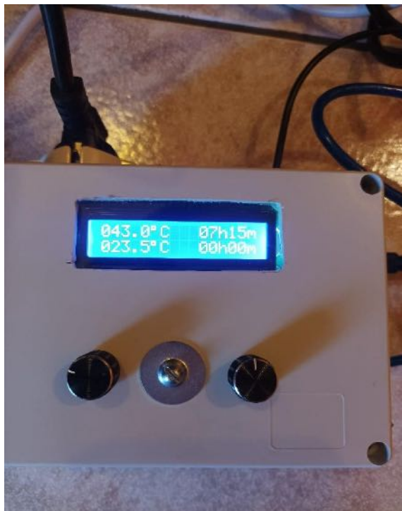
Fig. 21: display dello strumento con le relative impostazioni
