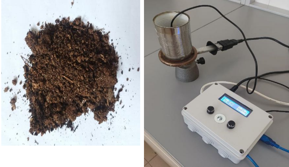
Fig. 15-16 : campione di terra di legno (a sinistra) e terra riscaldata sul riscaldatore collegato al dispositivo (a destra)
