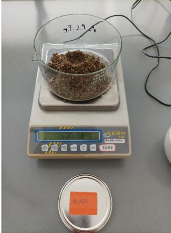
Fig. 5-6: terreno fluviale pesato sulla bilancia (a sinistra) e riscaldato sul riscaldatore (a destra)
