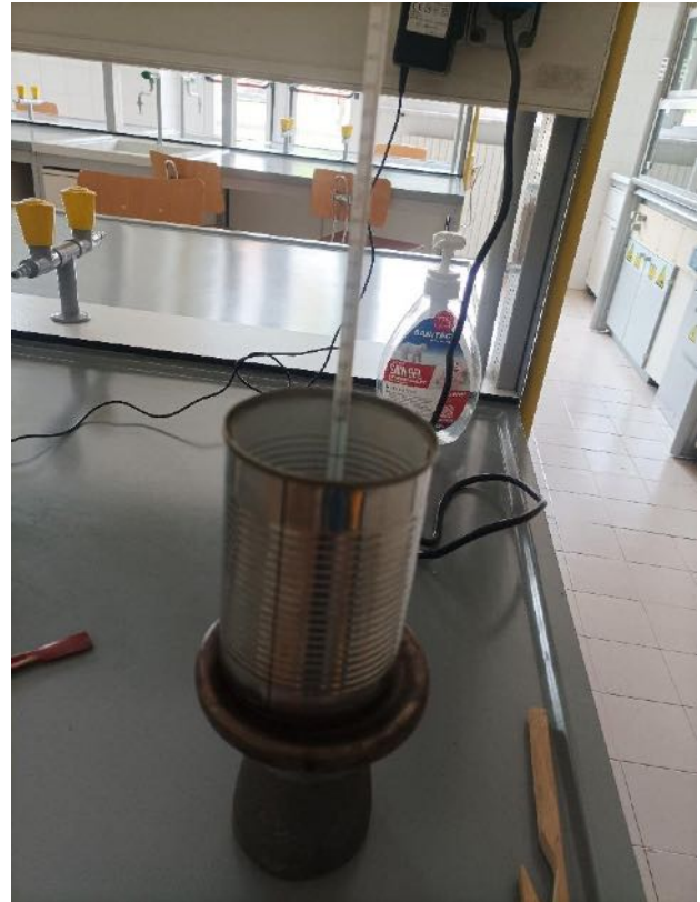
Fig. 9-10: terriccio di sottobosco pesato sulla bilancia (a sinistra) e riscaldato sul riscaldatore (a destra)
