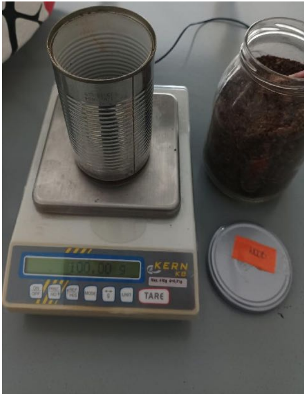
Fig. 9-10: terriccio di sottobosco pesato sulla bilancia (a sinistra) e riscaldato sul riscaldatore (a destra)
